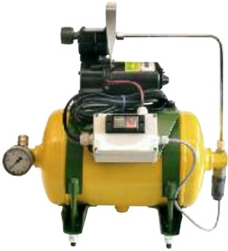
12 V-Kompressoraggregat, komplett mit Druckbehälter 10 l, grundiert, Kompressor 30 l/min, max. 8 bar, Steuerung mit Druckschalter, Schaltrelais, Überlastsicherung, Manometer, Ein/Aus-Schalter in robustem Gehäuse, Steckanschluss Gr. 3, Zuleitungskabel, Tragegriff, Spannbügel und Schraubkonsole
