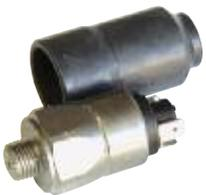
Druckschalter für Luftkompressor, Ein bei 5,6 bar, Aus bei 8 bar, Anschlussgewinde G 1/4", Schaltleistung max. 2 A bei 12 V
