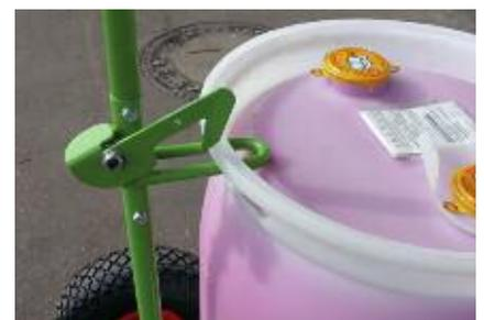
4. ChemKart® einfach an Agrotainer anfahren, Haltflasche in Griffloch einschieben, Sperrklinke rastet automatisch ein und los geht's, ohne den Behälter zu heben oder zu kippen.
