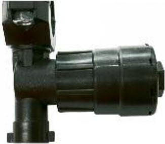
**Düsenschnittventil** zum Anbau an Membranventil-Düsenhalter aus Kunststoff (siehe auch Mehrfachdüsenhalter Seite 71/72), wird statt des vorhandenen Membranventils einfach aufgeschraubt, Anschluss an Druckluft (min. 4 bar, max. 8 bar) über Innengewinde G 1/8", Ventil öffnet mit Druckluft, schließt automatisch mit Federdruck
