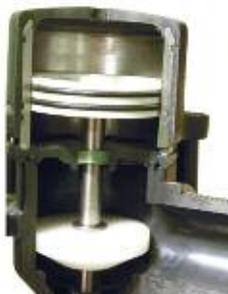
Der pneumatisch betätigte **Druckregler** erlaubt sehr hohe Regelgeschwindigkeiten. Dies ist besonders wichtig bei Computerregelungen zur Vermeidung von Regelverzögerungen bei Fahrgeschwindigkeitsänderung und damit verbundenen Fehldosierungen. Die Regelgeschwindigkeit kann beliebig eingestellt werden. Die Luftfeder, statt der Metallfeder eines herkömmlichen Reglers, bewirkt einen Gleichdruckeffekt bei Teilbreitenschaltung.
