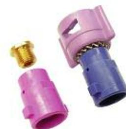
Universal-Injektoren können mit speziellen Adapterschrauben an allen Düsenkörpern mit Gewindeüberwurfmuttern und auch an Sonderbajonettkappen befestigt werden. Bei der Montage an Bajonettkappen wird eine spezielle Fächerscheibe aus Edelstahl als Verdrehsicherung eingebaut.
