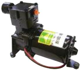
Luftkompressor 12 V, Ansaugleistung 30 l/min max., max. 8 bar, wartungsfrei, ölfrei, robuste Ausführung, Stromaufnahme max. 18 A, thermischer Überlastschutz, mit kurzem Anschlusskabel, ohne Schalter und Sicherungen
