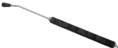
Verlängerungsrohr aus Stahl, verzinkt (Edelstahl auf Anfrage), mit beidseits Außengewinde G 1/4", passend zu Momentabstellventil 252, dazu passend Düsenhalter Messing Art.Nr. 164–M1/4–3/8, siehe Seite 70
