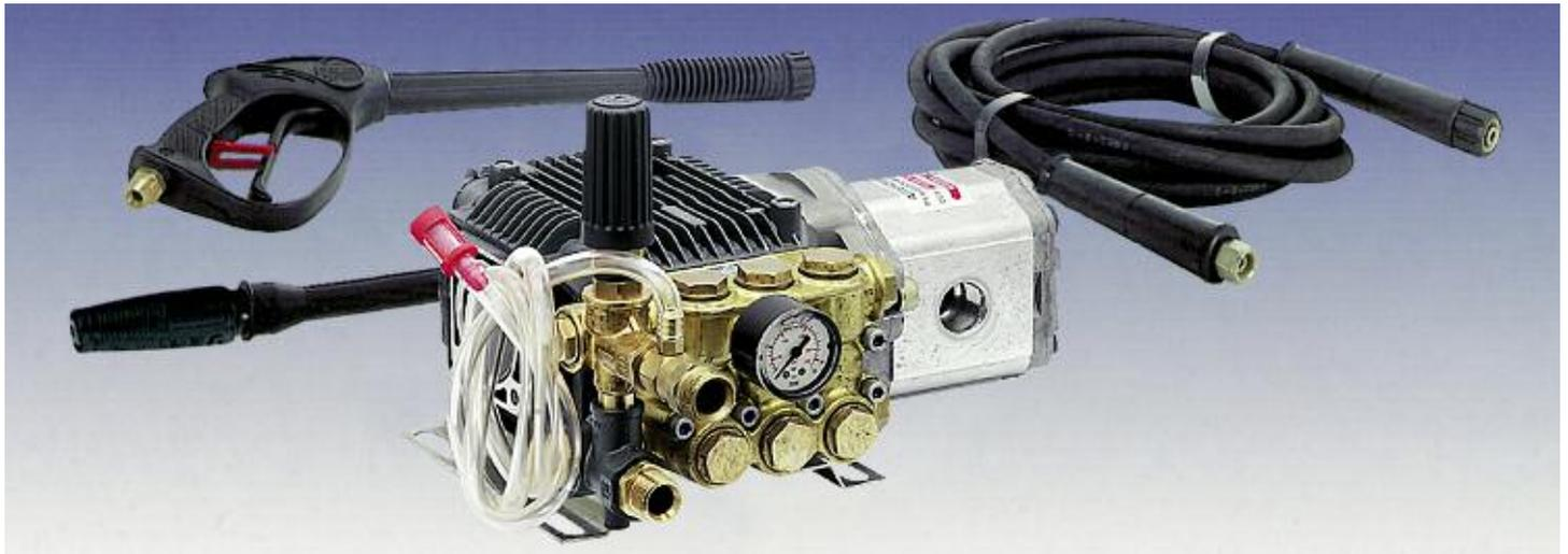
Hochdruck-Waschkit für Pflanzenschutzgeräte, bestehend aus Hochdruck-Kolbenpumpe mit Druckregler und direkt geflanschtem Ölmotor zum Anschluss an die Schlepperhydraulik, Hochdruckschlauch mit Reinigungspistole
