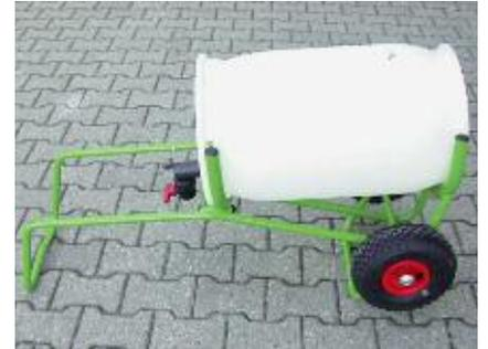
ChemTipper® einfach kippen, der Agrotainer ist angehoben und leicht geneigt zur optimalen Entleerung. Die Räder sind vom Boden, alles steht sicher.
