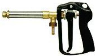
Einhandspritzpistole mit Strahlwinkelverstellung 0–45°, max. 40 bar, Ausstoß 3–4 l/min bei 10 bar je nach Strahlwinkel, Anschlussgewinde G 1/2", Schlauchtülle 10 mm, Wurfweite 2,5–9 m bei 10 bar
