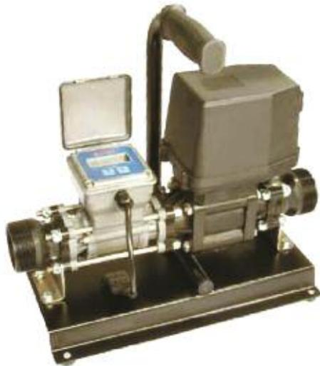
Tragbares Füllsystem mit induktivem Durchflussmesser und automatisch abschaltendem Kugelventil, wenn die voreingestellte Flüssigkeitsmenge erreicht ist. Das System ist mit beidseitig G 2"-Aussengewinde versehen und wird einfach nach der Füllpumpe in die Schlauchleitung geschlossen (auf ausreichende Überdrucksicherung 10 bar achten).
