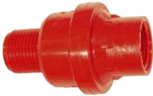
Das CF-Ventil hält einen bestimmten Druck (1,0/1,5/2,0 oder 3,0 bar) auf der Ausgangsseite unabhängig vom Eingangsdruck. In Verbindung mit einer Düse ergibt sich dadurch ein absolut konstanter Durchfluss.
