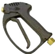
Momentabstellventil, max. 25 l/min und 200 bar, Eingang G 3/8" Innengewinde, Ausgang G 1/4" Innengewinde, flüssigkeitsführende Teile aus Messing/Edelstahl
